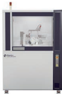
單晶X射線繞射儀 (小分子結構分析) XtaLAB Synergy-i
