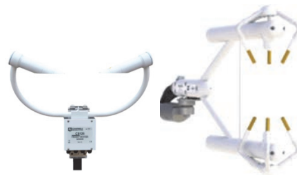
3 維風速風向/水氣/CO2 溫室氣體交換通量
