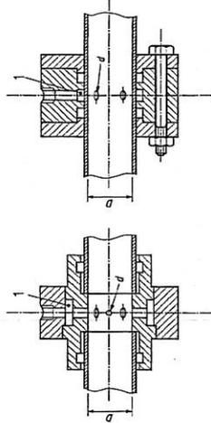
圖 2 鑽孔式測壓孔與其環室的範例
