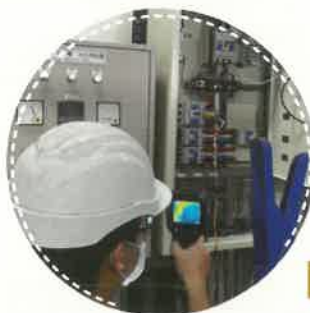
電力盤熱點量測
