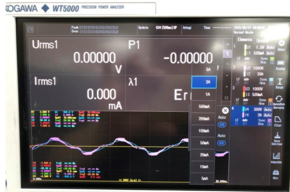
圖 2 具 7 檔以上量程及寬範圍電壓量測
