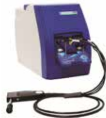
I-Raman Plus®/提供 532nm,785nm,1064nm 雷射
