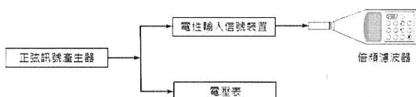
圖 1 倍頻濾波器平坦頻率響應檢測系統圖
