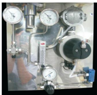
煙道氣體分析處理採樣系統
