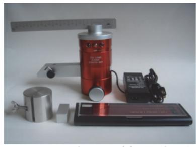
3086T 電動鉛筆硬度計
