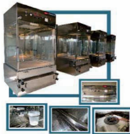
禽流感負壓隔離艙 (實驗：農委會動物防疫檢驗局)
