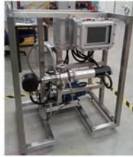
液體製程分析系統 (水中油份、油中水份等)
